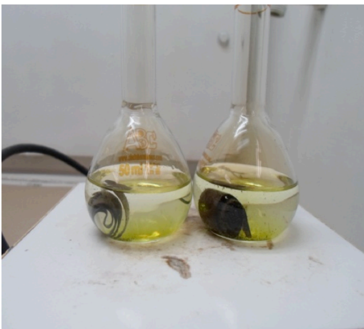
Figura 3. Aleaciones d oro enrolladas en espirales para la lixiviación con \text{HNO}_3
