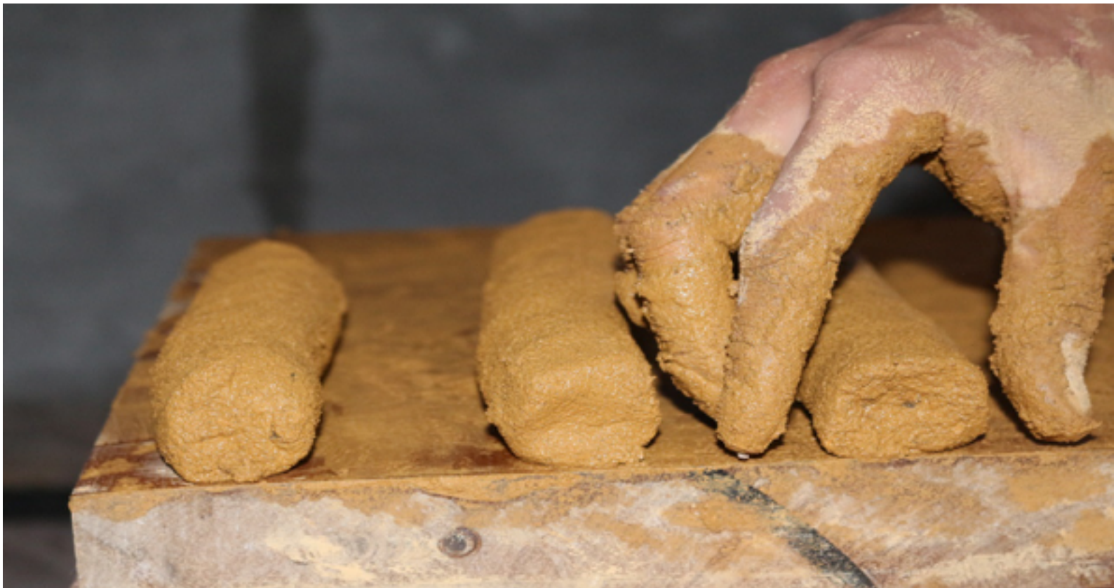
Figura 5: Charutos moldados para medir adequação do solo. Fonte: Bittencourt, Silva.
