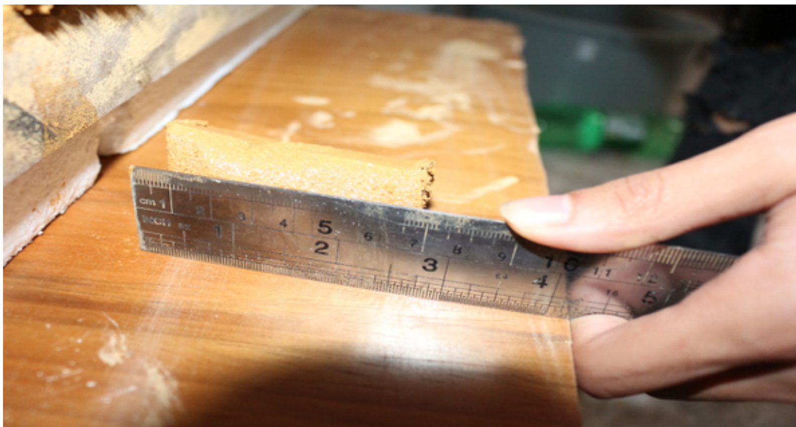
Figura 6: Momento em que o charuto quebrou ao ser empurrado; Tirada de medida C1: 6,8 cm. Fonte: Bittencourt, Silva.
