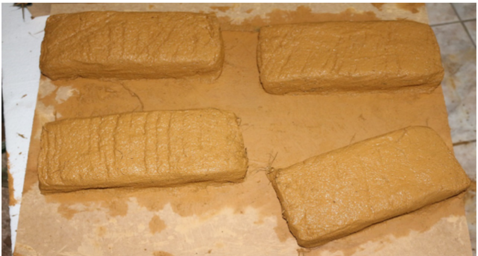
Figura 9: Tijolos de adobe dividido em quatro partes; Dimensões: 7, 11, 20,5 cm; Fonte: Bittencourt; Silva.
